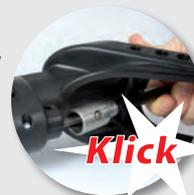
Il carter di aspirazione a molla impedisce la mancanza di contatto con la superficie durante la preparazione, compensa i dislivelli
